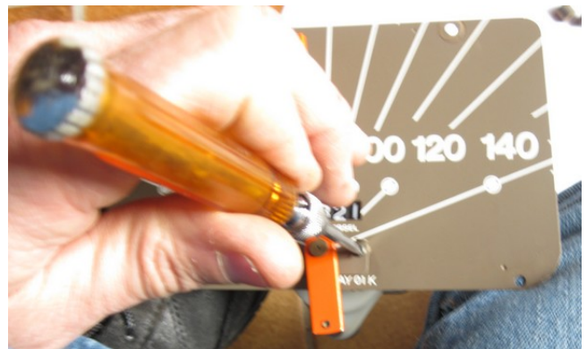
8 – Dévisser la plaque butée d'aiguille
