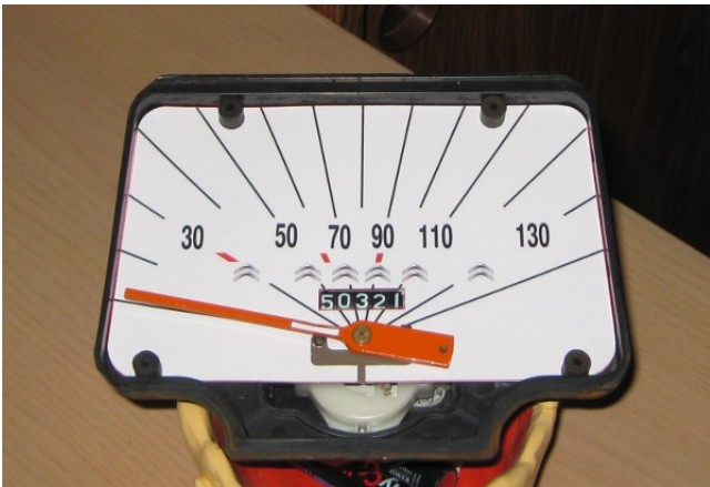
13 – Glisser le compteur dans son support et repositionner les caoutchoucs
